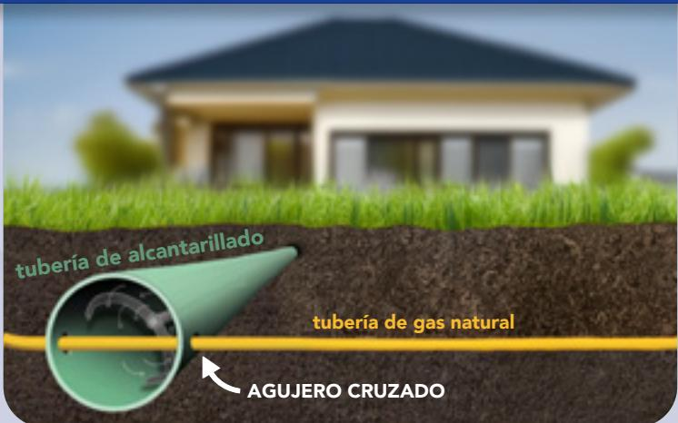
Los fontaneros y propietarios de viviendas suelen utilizar un cortador rotatorio para desatascar las tuberías de alcantarillado. Si bien esta herramienta es útil para eliminar obstrucciones como raíces de árboles, también puede cortar tuberías de gas natural u otras tuberías subterráneas de servicios públicos que intersecan accidentalmente la línea de alcantarillado.
