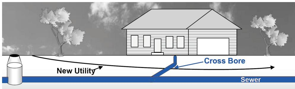
A veces, la tubería de gas que sirve a una casa se instala accidentalmente de modo que cruza la tubería de alcantarillado. Esto se denomina perforación cruzada, que puede ocurrir cuando se usa tecnología sin zanjas para instalar tuberías de gas o cuando las líneas de alcantarillado no se mapearon o instalaron con tecnología localizable.
